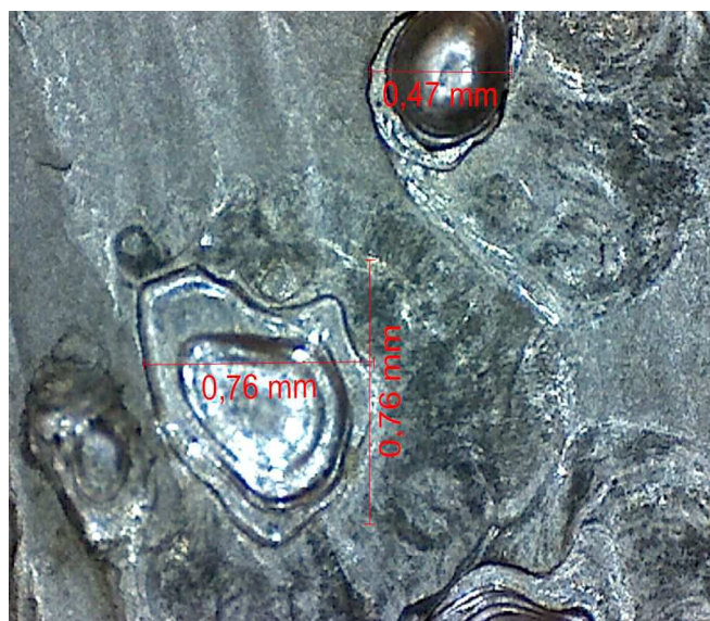
Рис. 1. Зона электрического пробоя на образце из стали 20X13
